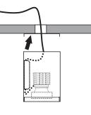
Encaixe o corpo da luminária na chapa de fixação
