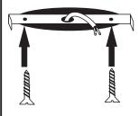
Fixe a chapa no teto e coloque e passe os cabos da rede pela abertura
