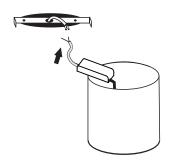
Com a rede elétrica desligada, ligue os cabos do driver que está dentro do corpo da luminária.
